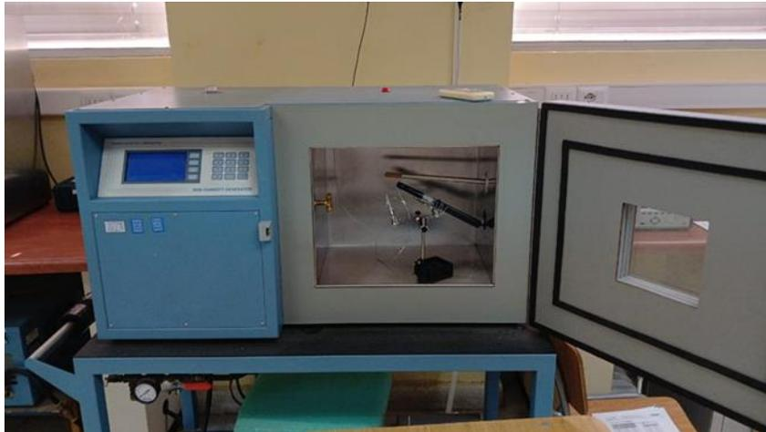
Figura 3. Montaje para la calibración del patrón viajero.
